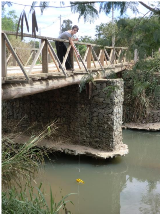
Figura 8- Coleta de amostra de sedimentos em suspensão no rio Vidoca próximo a sua desembocadura no Rio Paraíba do Sul.
