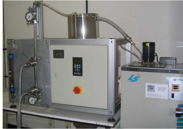
**Figura 1.** Modulo de filtração utilizado no processo de coagulação/floculação.
