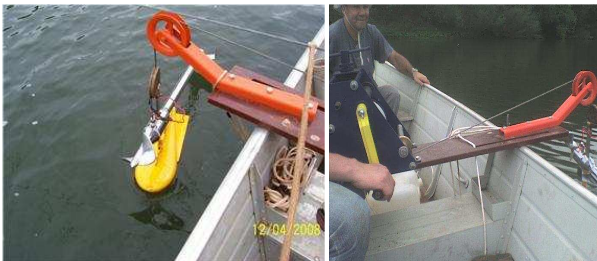
Figura 2 - Molinete hidrométrico MLN-07 acoplado ao lastro e guincho, ara medição de vazão no rio Piquiri.
