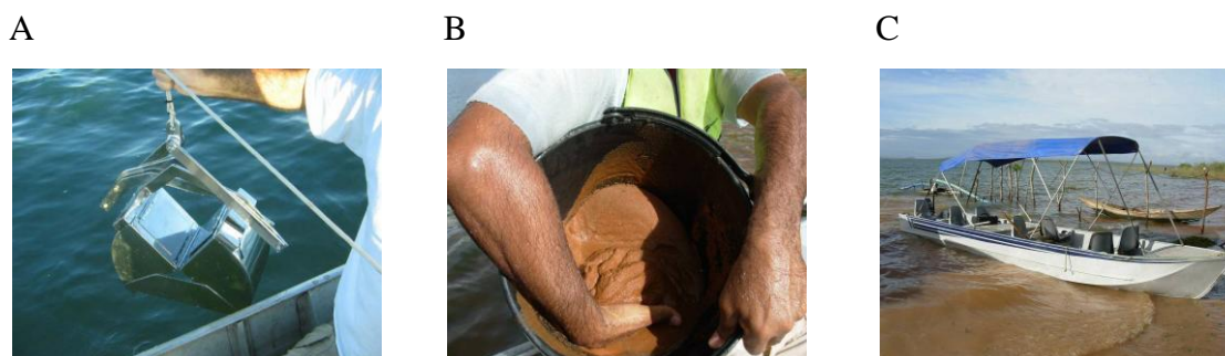
Figura 1 – Coleta de sedimentos: (A) draga modelo Petite Ponar e (B) homogeneização do sedimento dos pontos C,M,J e (C) Barco tipo voadeira, equipada com motores Yamaha de 25 e 40 HP. (CHESF, 2008).
