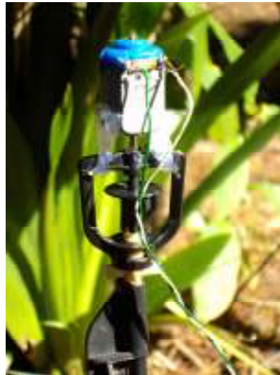
Figura 3 – Montagem experimental com o microaspersor e o motor utilizado como gerador.
